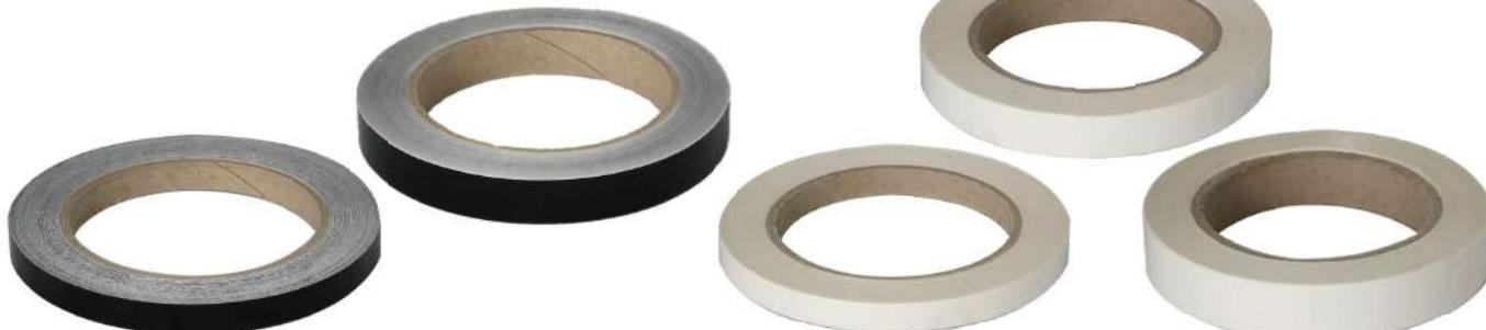
エアフリータイプのフィルムの場合、エアフリー満に水やホコリ等が入り込み施工後に剥がれてくる可能性がございます。エッジガードテープはペタ糊ですので、フィルム施工後、端部に貼る事により侵入を防ぐ事ができます。また、長期使用していると端部の粘着力が弱くなりフィルムが剥がれてくる場合がございます。そういう粘着力の落ちてしまったフィルムを補強する事ができます。
